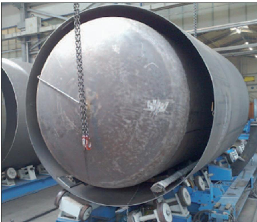
Abb. 2: Fertigung eines VSI-Tanks
