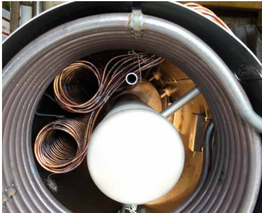
Jenni fertigt Wärmepumpenspeicher, bei denen der Kondensator der Wärmepumpe im Speicher integriert ist.
